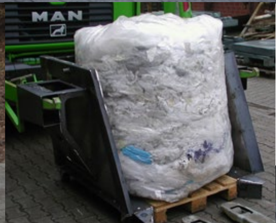
Ballenaufnahme-Adapter als Kipphilfe für Pressmüllwagen
