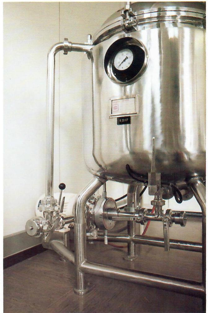
FRYMA-Zahnkolloidmühle verbunden mit einem Mischbehälter im Umlaufverfahren.
