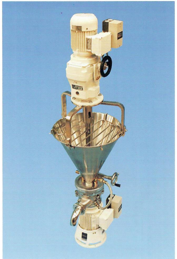
FRYMA-Mühle mit Schnecken-Zuführung für stark pastöse Produkte.
