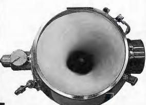
Der Innenschliff von Mischbehälter, Deckel und des Auslaufgehäuses sowie der Schliff der Mischwerkzeuge erfolgt mit 320er Korn. Sämtliche Teile
